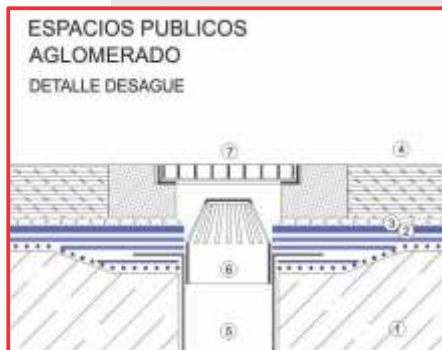
1 Soporte resistente - 2 Imperla Parking - 3 Riego asfáltico - 4 Aglomerado asfáltico - 5 Drenaje - 6 Filtro - 7 Rejilla.
