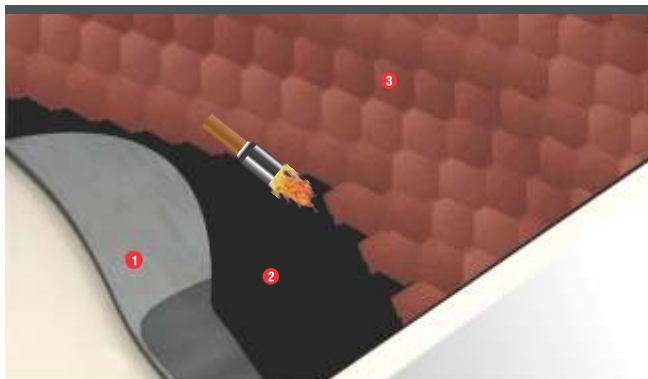
Figura 1 Sistema soldada sobre losa
