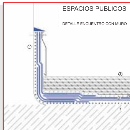
1 Soporte resistente - 2 Imperla Parking - 3 Riego asfáltico - 4 Pavimento de mezcla asfáltica - 5 Encuentro con muro
