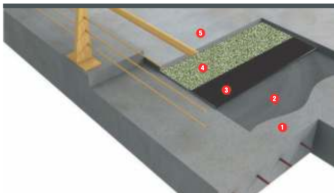
Figura 3 Bicapa con Mineralizada
