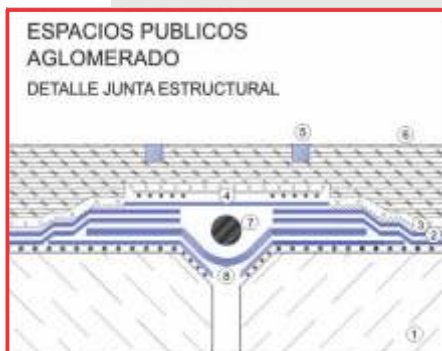
1 Soporte resistente - 2 Imperla Parking - 3 Riego asfáltico - 4 Placa metálica - 5 Masilla - 6 Aglomerado asfáltico - 7 Imperla Rond 30 - 8 Imperla Plus Geo
