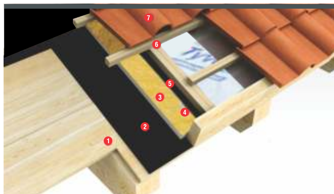
Figura 2 Sistema con lana de vidrio y Tyvek
